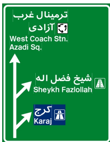
شکل (۶) - نحوه رنگ بندی در هدایت به سمت آزاد راه در تابلوی راهنمای مسیر بزرگراهی
