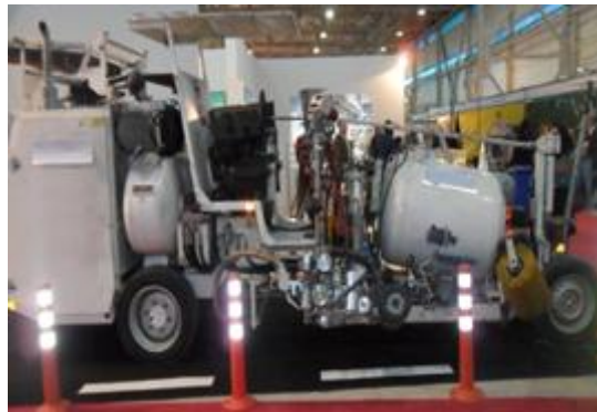
تصویر (۱۶): نمونه‌ای از خودرو خطزن محوری با رنگ دوجزئی
