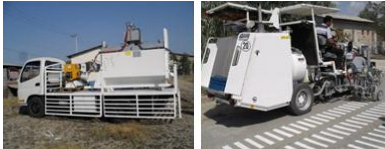
تصویر (۱۵): نمونه‌ای از تجهیزات اجرای خط‌کشی با رنگ گرم
