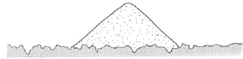
الف: حجم معینی از ماسه ریز با اندازه ذره‌ای یکنواخت که بر سطح جاده ریخته می‌شود
