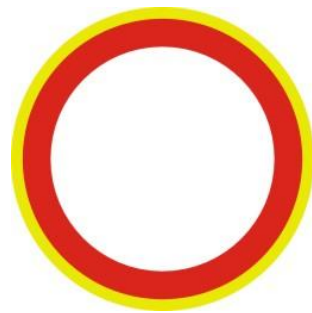
شکل ۱ - نمایش حاشیه فلورسنت تابلو انتظامی
