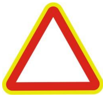
شکل ۲- نمایش حاشیه فلورسنت تابلوهای اخطاری
