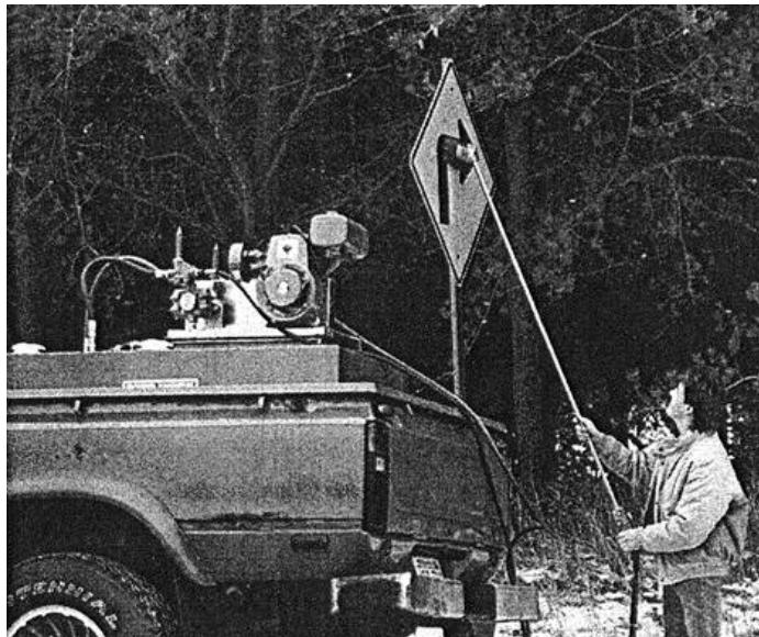
شکل ۲-۳- نحوه نظافت تابلو
