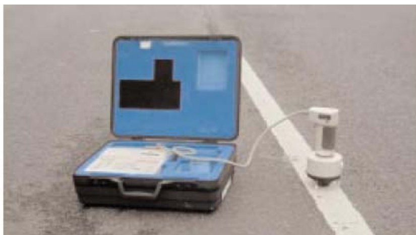
شکل ۳-۵: دستگاه اندازه‌گیری میزان درخشندگی خط‌کشی‌ها
