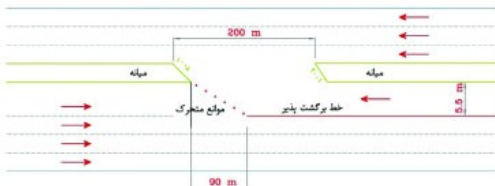
شکل (۲۱). محل انتهایی خط برگشت پذیر در یک بزرگراه با وجود میانہ.
