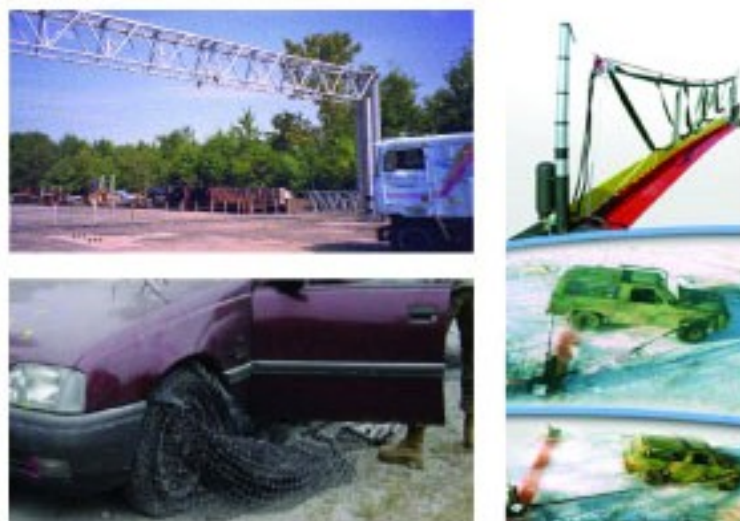
شکل (۱۸). سیستم کابل سهار کننده وسایل نقلیه.
