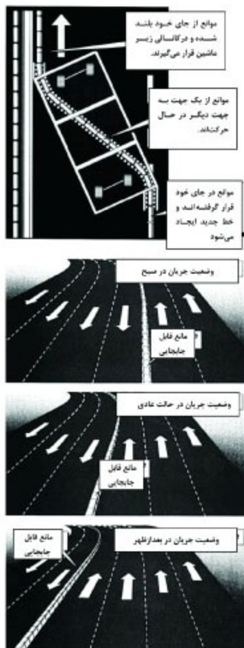
شکل (۱۰). نحوه جابه‌جایی موانع بتنی توسط وسیله مخصوص
